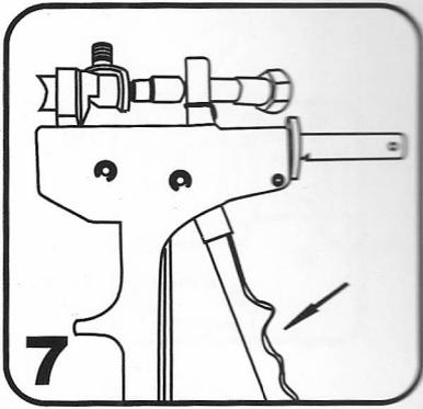
7. Actionner la poignée jusqu'à ce que la bague recouvre totalement le tube et arrive en butée sur le raccord.
