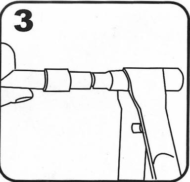
3. Ecarter le tube PER avec la pince à emboîture. **IMPORTANT:** écarter le tube progressivement et avec un mouvement de rotation.
