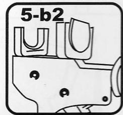
5-A-1 Pour le montage de la majorité des raccords, il est nécessaire d'introduire les « berceaux (12, 16 ou 20) » ou les « berceaux butoirs (3/8" ou 1/2" -3/4") » dans les « porte-berceaux » («PORTACUNAS»).
